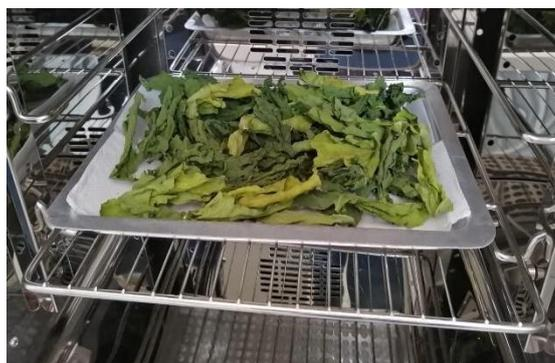
IMAGEN 4: se colocó las hojas en un lugar bajo sombra y con suficiente ventilación. “Posteriormente se secó totalmente la muestra en estufa a 40°C por 12 h.
