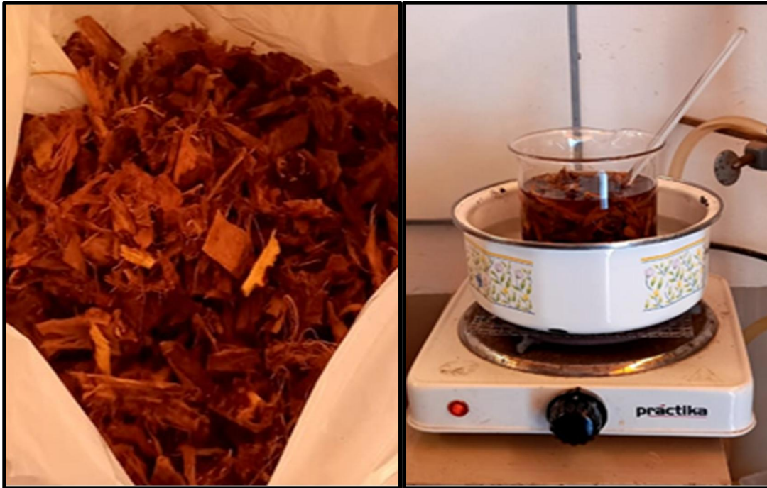
Figura 4: Foto de corteza picada y luego en baño maria embebido en etanol al 96 %.
