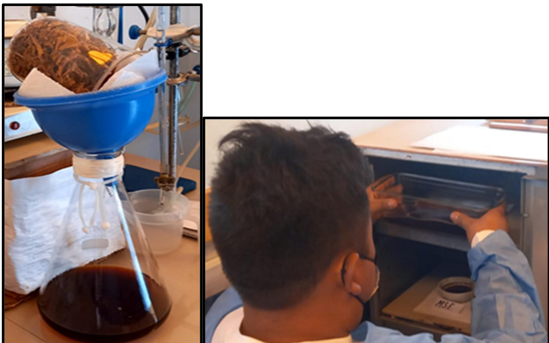
Figura 5: Foto del filtrado de resina de bertholletia excelsa y posteriormente se coloca en la estufa a 40 grados por 24 horas.
