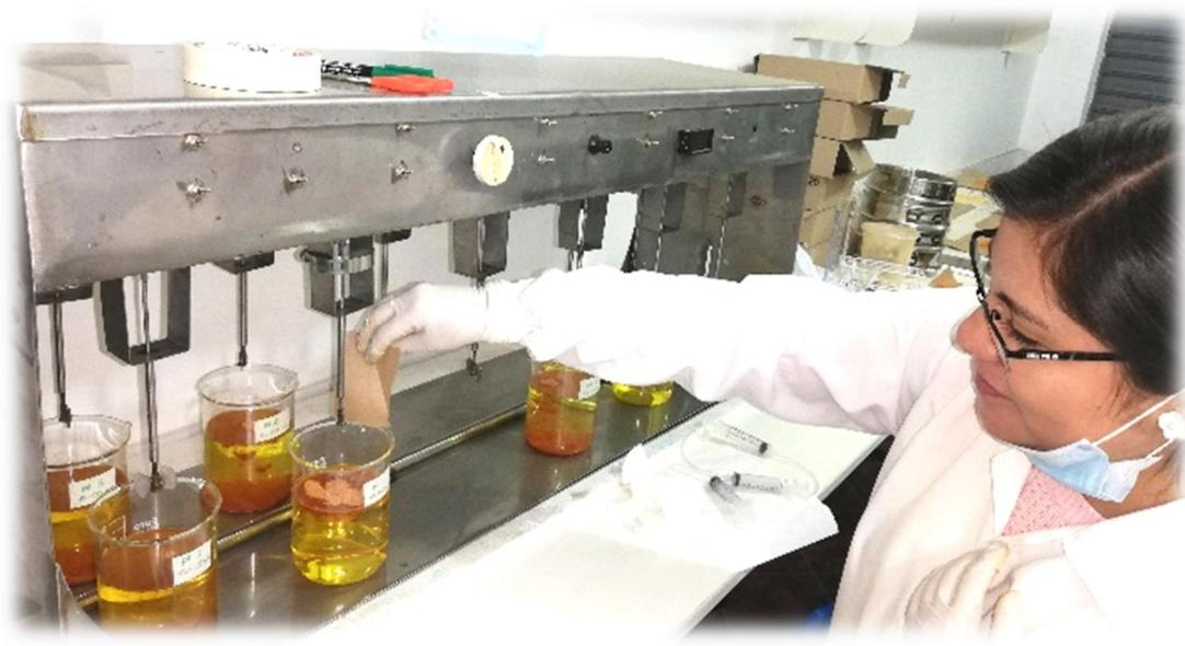
**Realizando las pruebas con el equipo Batch**
