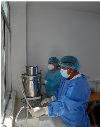
Figura 4. Instalación del equipo de destilación por arrastre de vapor
