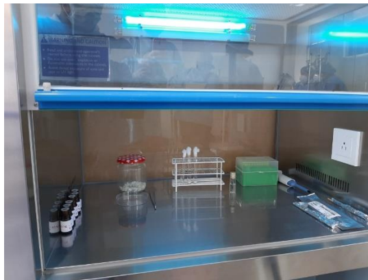
Figura 9. Preparación del material y equipos de trabajo para microbiología. Esterilizado previo con luz UV
