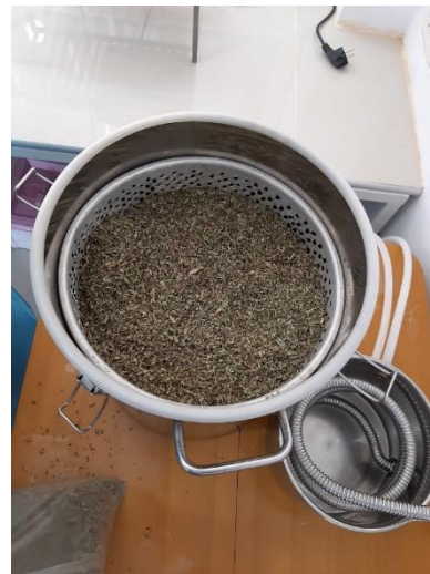
Figura 3. Muestra de orégano en equipo de destilación con arrastre de vapor
