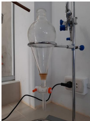
Figura 7. Proceso de recolección y separación de las fases acuosa y oleosa del aceite esencial
