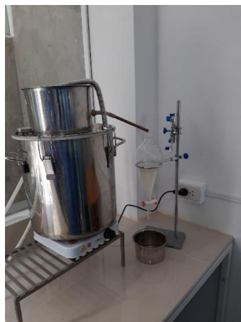
Figura 6. Instalación y funcionamiento de equipo de destilación con arrastre de vapor
