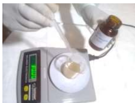
Figura 17: incorporación del látex de Ficus obtusifolia Kunth (“sugo”) Fuente: Elaboración Propia
