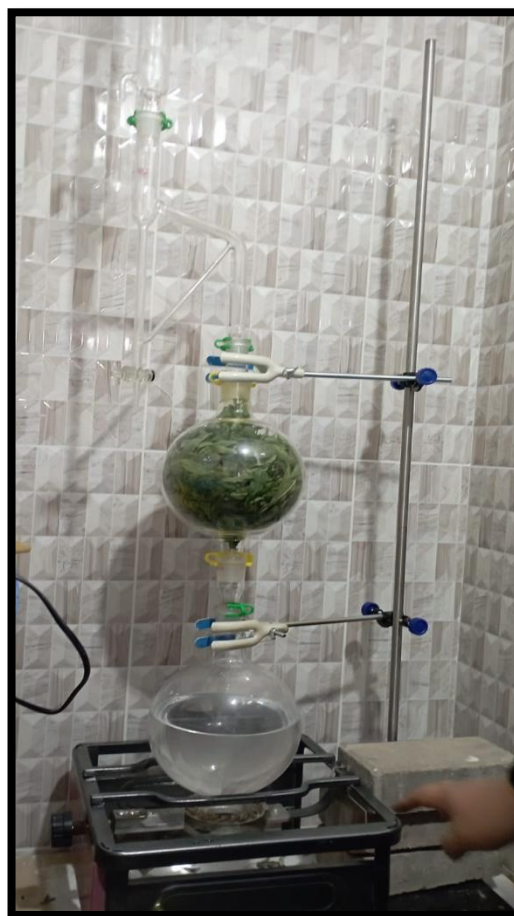
Extracción del aceite esencial de Tagetes minuta por arrastre de vapor
