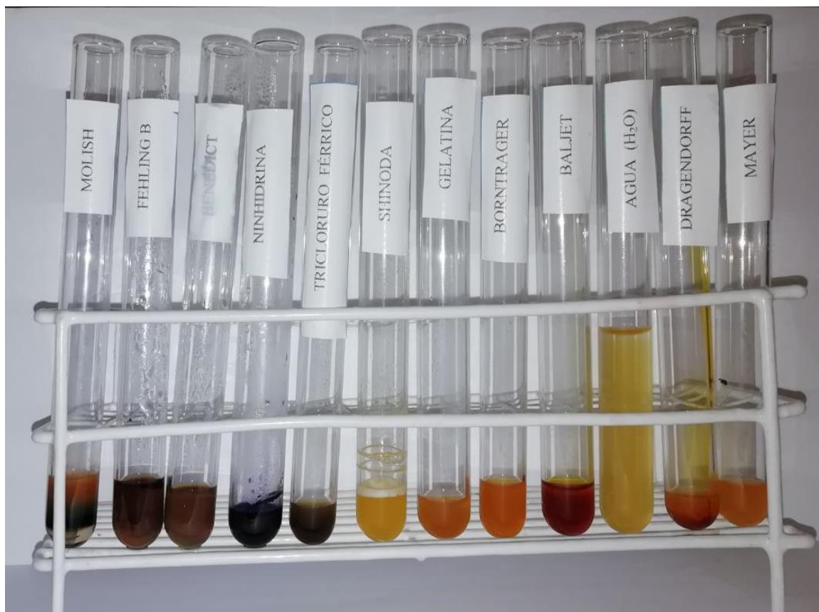
Fig 29. Pruebas de coloración y precipitación.
