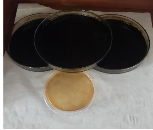
Figura 13 y 14. Secado del extracto etanólico y hidroalcohólicos del Neltuma pallida
