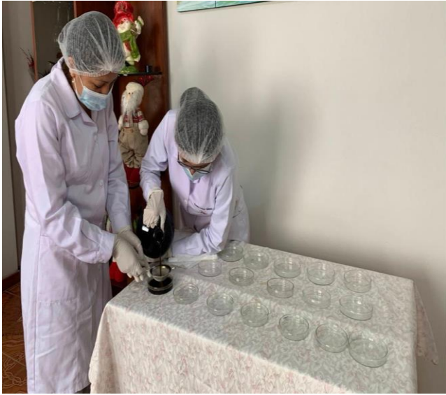
Fig. 8 Proceso de filtración del extracto hidroalcohólico de Rumex Frutescens Thouars “cuturromanza”
