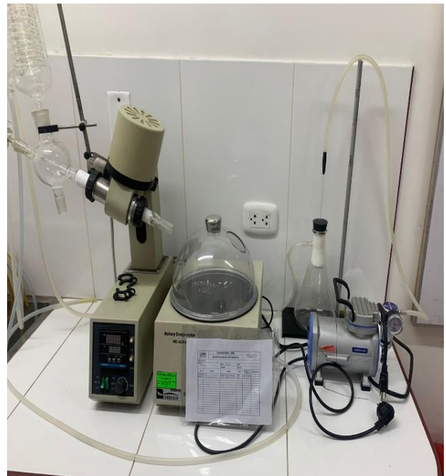
Fig. 9 Proceso de evaporación del extracto hidroalcohólico de Rumex Frutescens Thouars “cuturromanza” realizado mediante baño maría, rotavapor y en la estufa.
