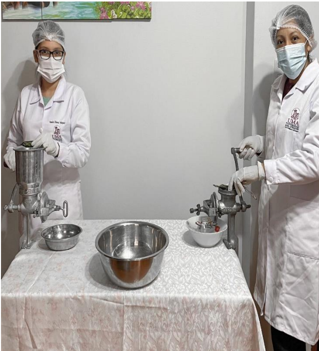
Fig.6 Proceso de molienda o triturado de la muestra de Rumex Frutescens Thouars "cuturromanza"
