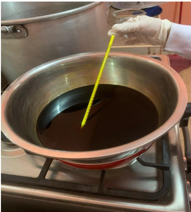
Fig. 9 Proceso de evaporación del extracto hidroalcohólico de Rumex Frutescens Thouars “cuturromanza” realizado mediante baño maría, rotavapor y en la estufa.
