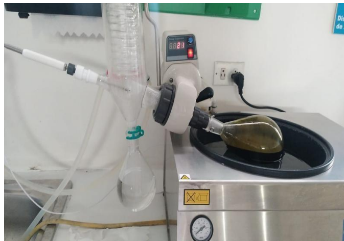
Figura 6. Proceso de evaporación mediante el rotavapor de la especie vegetal en estudio.
