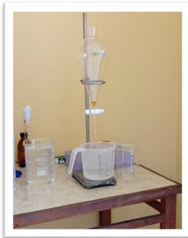
Figura 10. Extracción y decantación del aceite esencial de M. mollis
