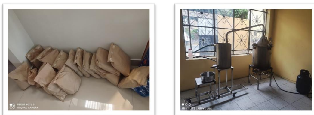
Figura 8. Pesado y cargado de las hojas secas al equipo de extracción
