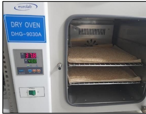
Figura 4. Procedimiento de secado de la muestra
