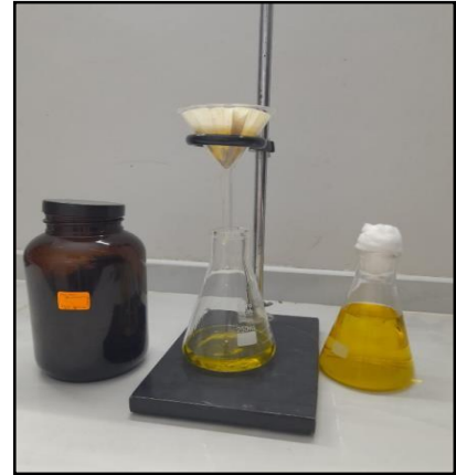
Figura 10. Procedimiento de filtración del macerado del extracto etanólico
