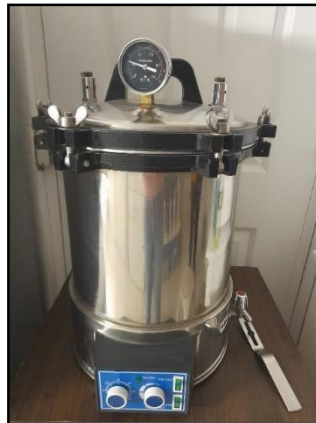
Figura 20. Autoclave para el uso en la prueba microbiológica
