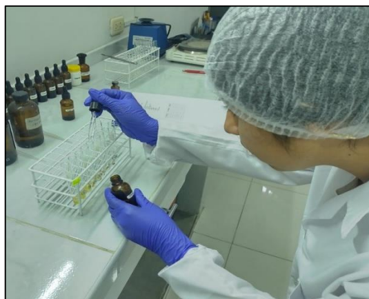
Figura 12. Añadiendo extracto seco al tubo de ensayo para prueba de solubilidad
