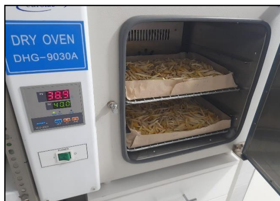
Figura 7. Procedimiento de secado de la muestra
