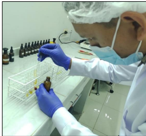
Figura 15. Adición de extracto a los tubos de ensayo
