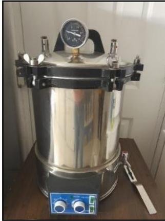
**Figura 14. Autoclave para el uso en la prueba microbiológica**
