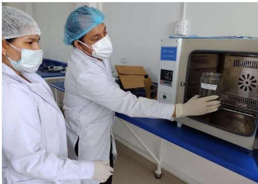
Figura 10. Evaporación del solvente en estufa
