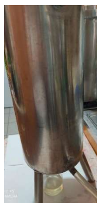
Destilación por arrastre de vapor
