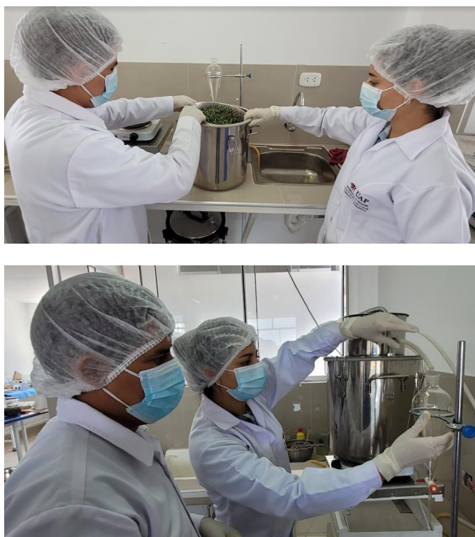
Figura 3. Instalación del equipo de arrastre por vapor
