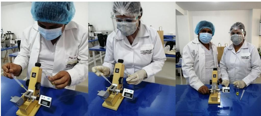
Figura 16. Determinación del índice de refracción del aceite de moringa
