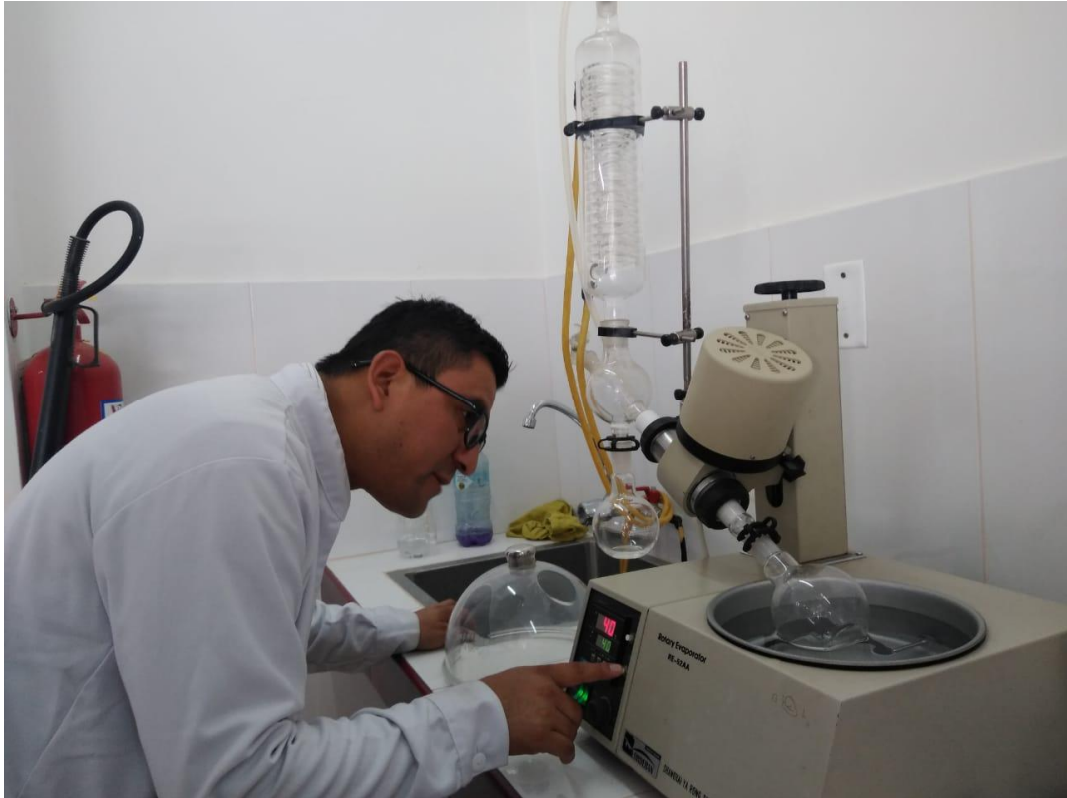
Ayuda del docente de práctica, en la regulación y calibración del equipo rota evaporador.
