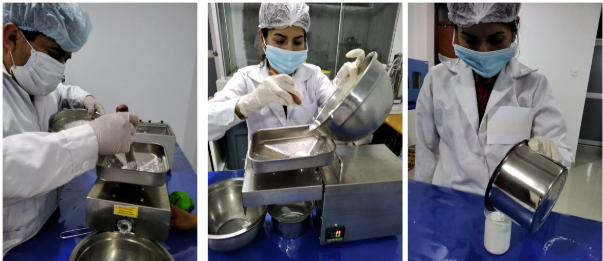
Figura 9. Extracción del aceite de coco por prensado en frío
