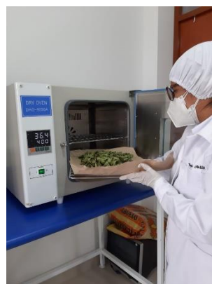
Figura 3. Secado de la muestra en estufa
