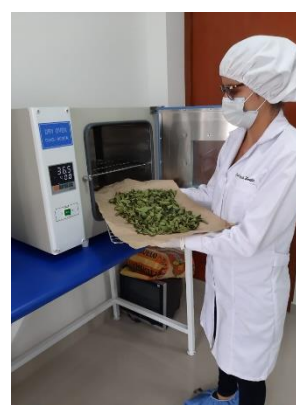
Figura 3. Secado de la muestra en estufa
