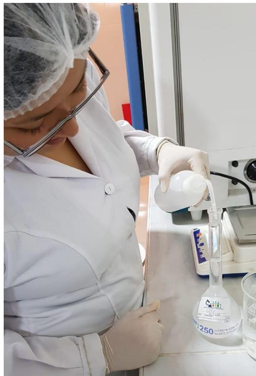
**Figura 11.** Elaboración de solución de EDTA 0.44 M
