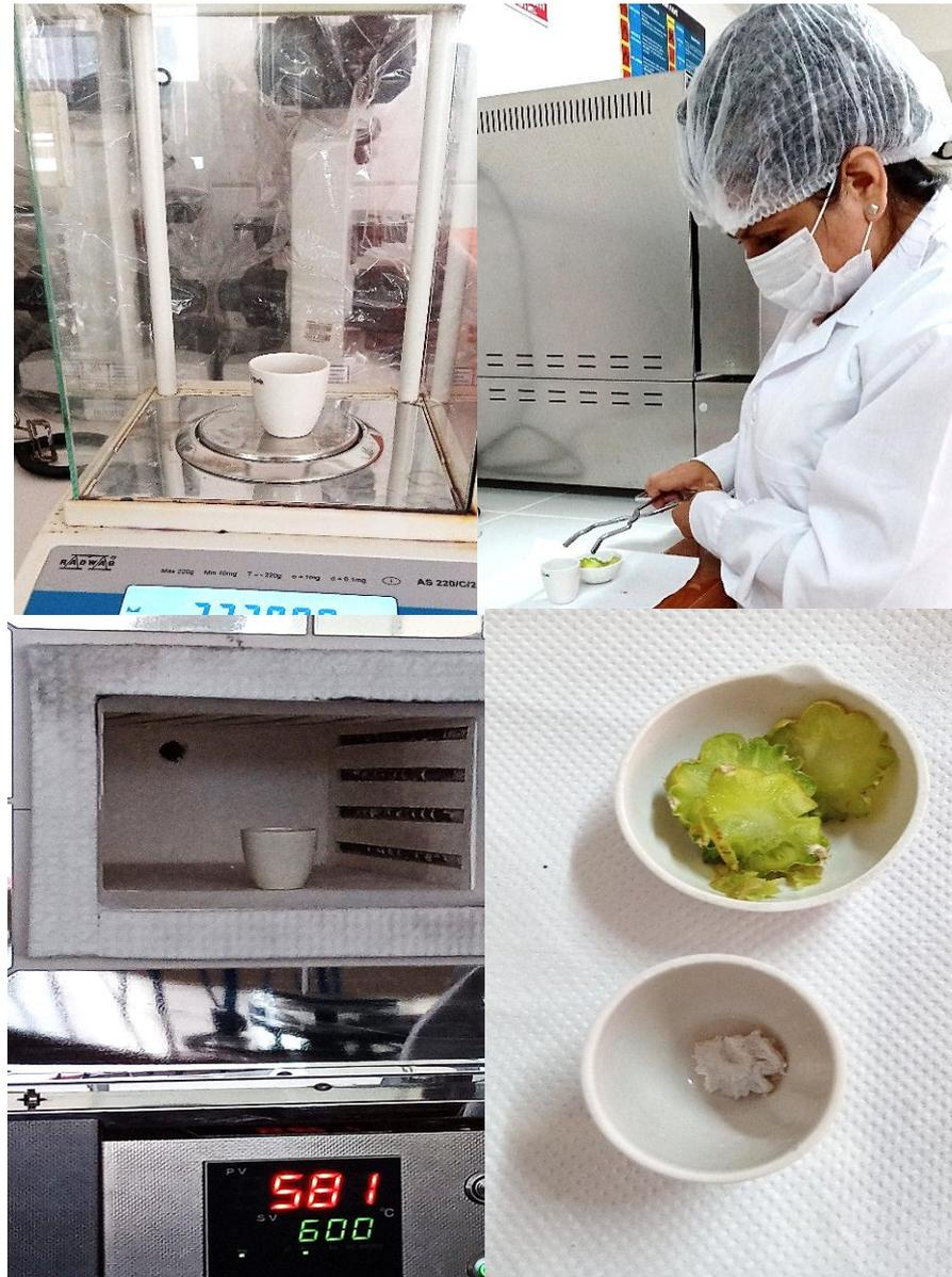
Figura 14. Determinación del parámetro de Cenizas por método de incineración de cenizas de la penca fresca de *Austrocylindropuntia Floccosa* (M.) Arakaki “huaguro”.
