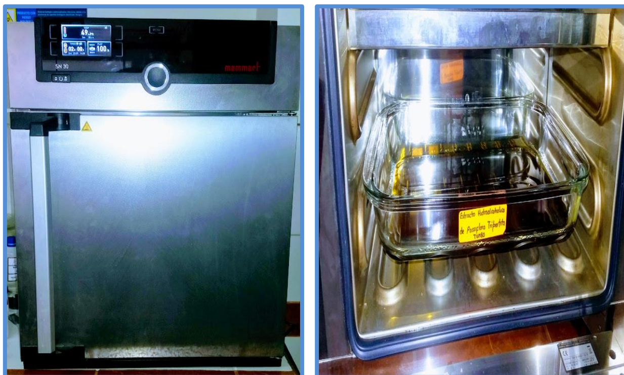
Figura N°16. Secado del extracto hidroalcohólico de Passiflora tripartita “Tumbo” en estufa a temperatura de 38 °C.
