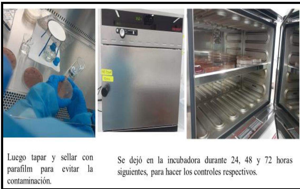
Figura 38. Incubación en una estufa a temperatura de 35°C durante 24, 48 y 72 horas
