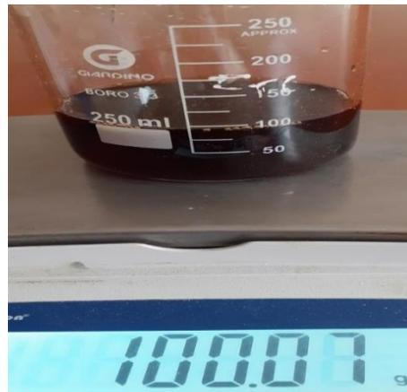
Se pesó en un beaker con balanza analítica
