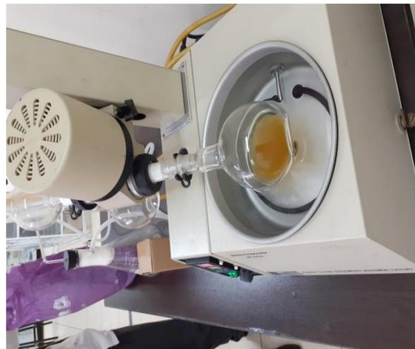
Proceso de disecado se realizó mediante ROTAVAPOR por 5 horas aproximadamente
