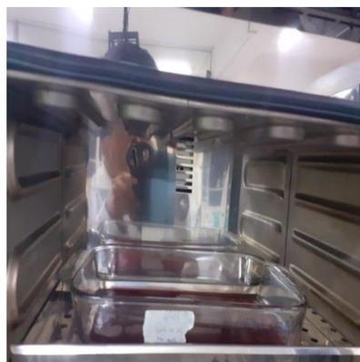
Proceso de disecado del zumo de *Punica granatum* se colocó a una estufa a temperatura de 40°C por 24 horas.
