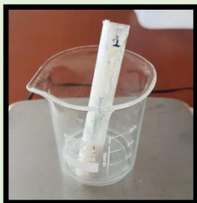
Pesar y colocar la crema en cada tubo de ensayo
