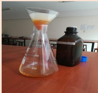
Filtración en un beacker limpio
