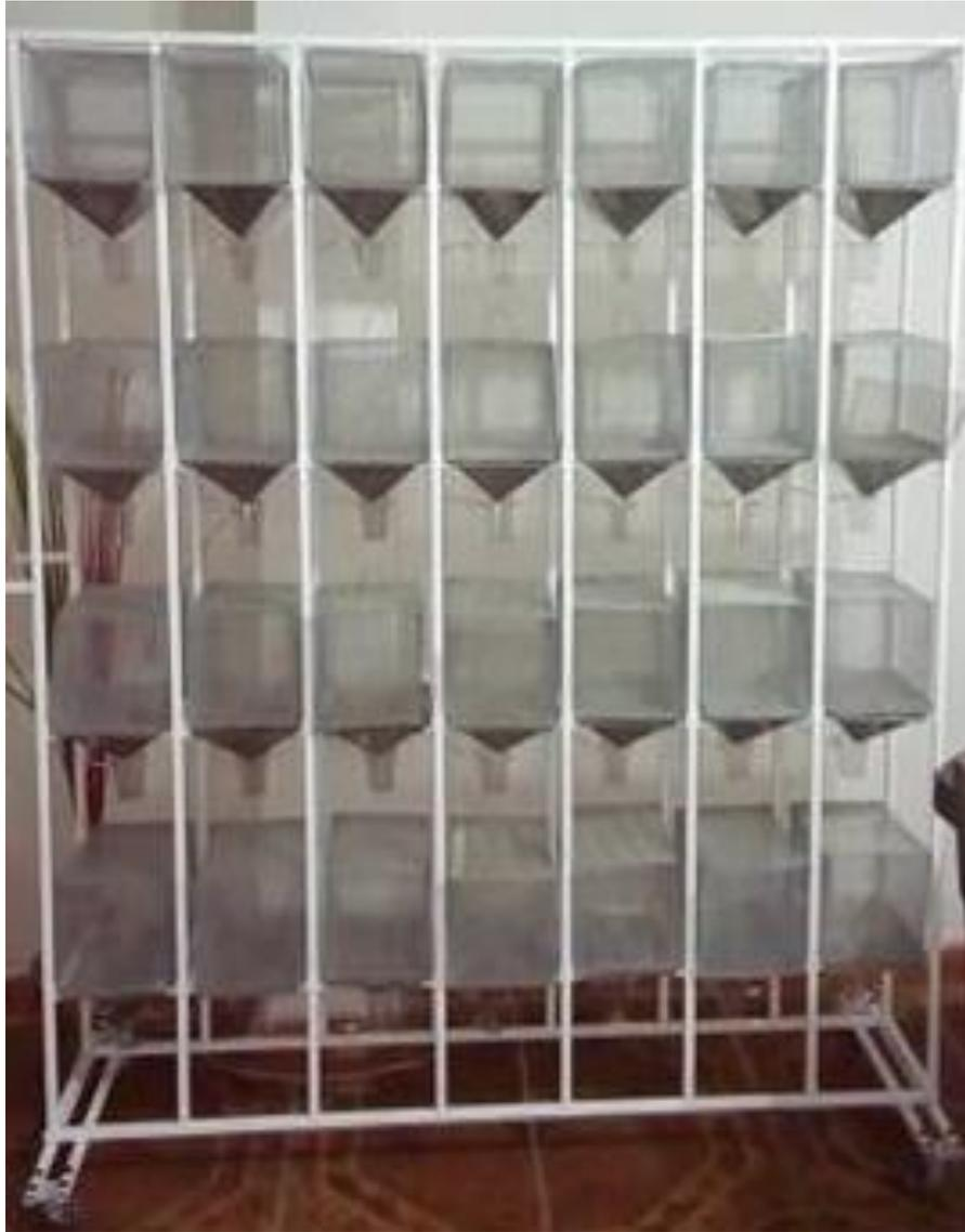
**Figura N° 19: Fabricación de las Jaulas metabólicas.**
