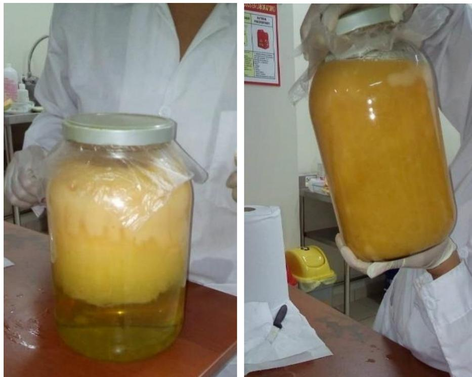
**Figura N° 25: Procedimiento de maceración del extracto hidroalcohólico (Pulpa y alcohol 70%) por 7 días**
