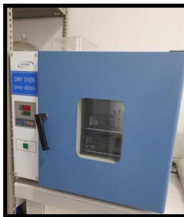
**Figura 9. Obtención de extracto seco**
