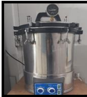
Figura 15. Autoclave para el uso en la prueba microbiológica
