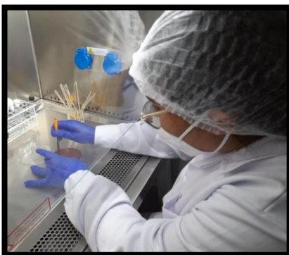
Figura 22. Efectuando pozos en agar con ayuda de un sacabocado
