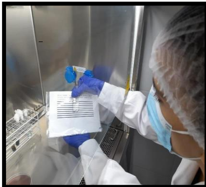
Figura 19. Comparación de turbidez mediante el reactivo de Mc. Farland
