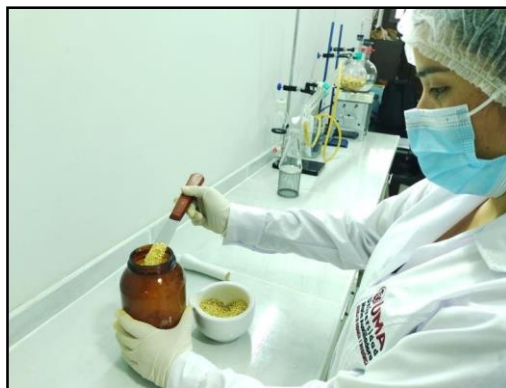
Figura 7. Preparación del macerado del extracto etanólico
