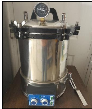
Figura 15. Autoclave para el uso en la prueba microbiológica
