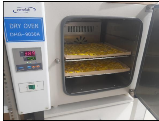
Figura 5. Procedimiento de secado de la muestra
