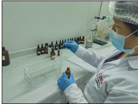
Figura 10. Añadiendo extracto seco al tubo de ensayo para prueba de solubilidad
