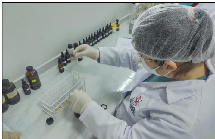
Figura 10. Añadiendo extracto seco al tubo de ensayo para prueba de solubilidad
