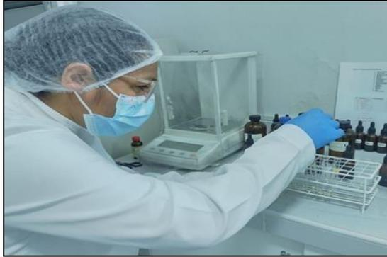
**Figura 1.** Adición de aceite esencial al tubo de ensayo para prueba de solubilidad
