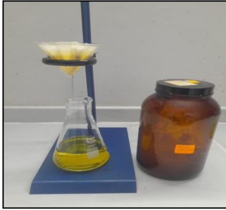
Figura 8. Procedimiento de filtración del macerado del extracto etanólico
