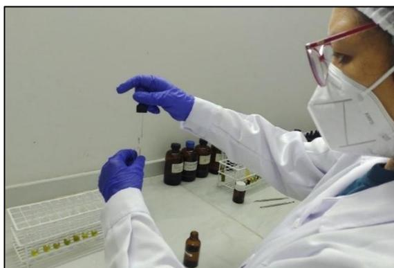
**Figura 10.** Añadiendo extracto seco al tubo de ensayo para prueba de solubilidad
