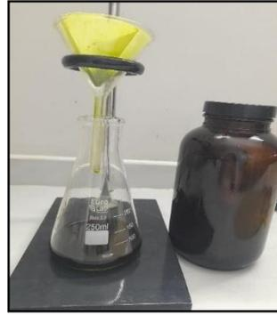
**Figura 7.** Procedimiento de filtración del macerado del extracto etanólico
