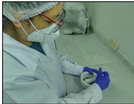
**Figura 4.** Procedimiento de molienda de la muestra
