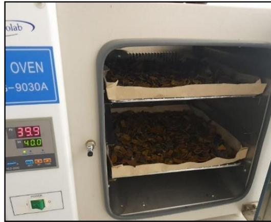
**Figura 5.** Procedimiento de secado de la muestra
