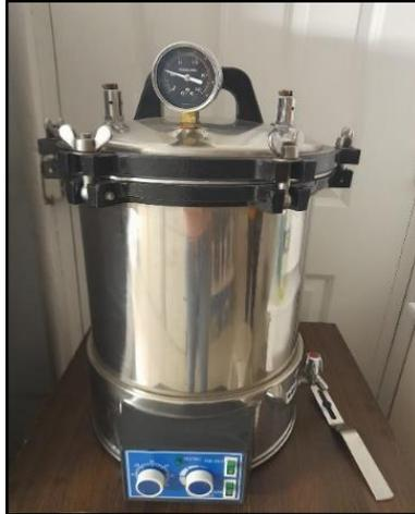
**Figura 15.** Autoclave para el uso en la prueba microbiológica
