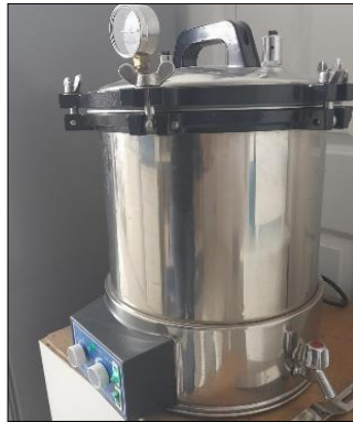
Figura 18. Autoclave para el uso en la prueba microbiológica
