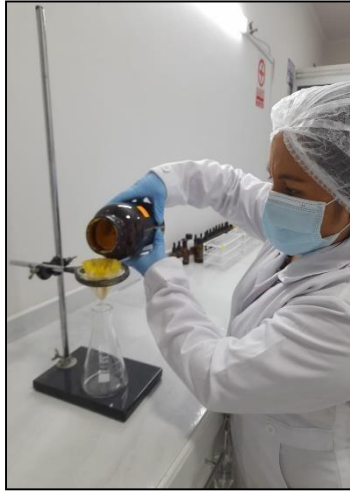
Figura 8. Procedimiento de filtración del macerado del extracto etanólico
