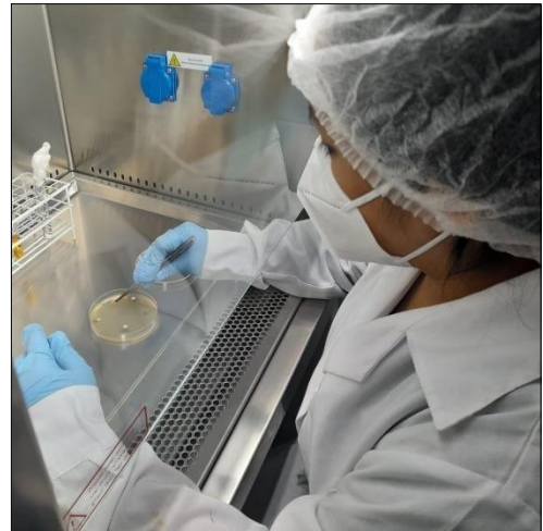
Figura 26. Adición de discos previamente preparados
