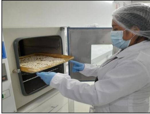
Figura 5. Procedimiento de secado de la muestra
