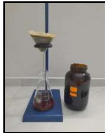
**Figura 9.** Procedimiento de filtración del macerado del extracto etanólico
