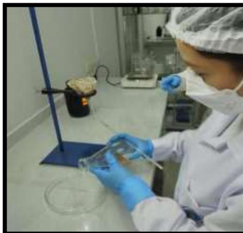
**Figura 10.** Proceso de vertido en placas
