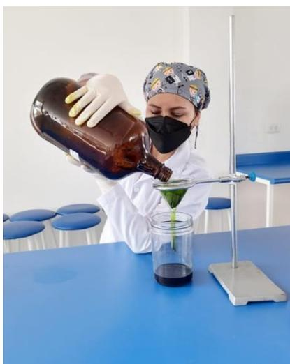
**Figura 6. Evaporación del solvente**
