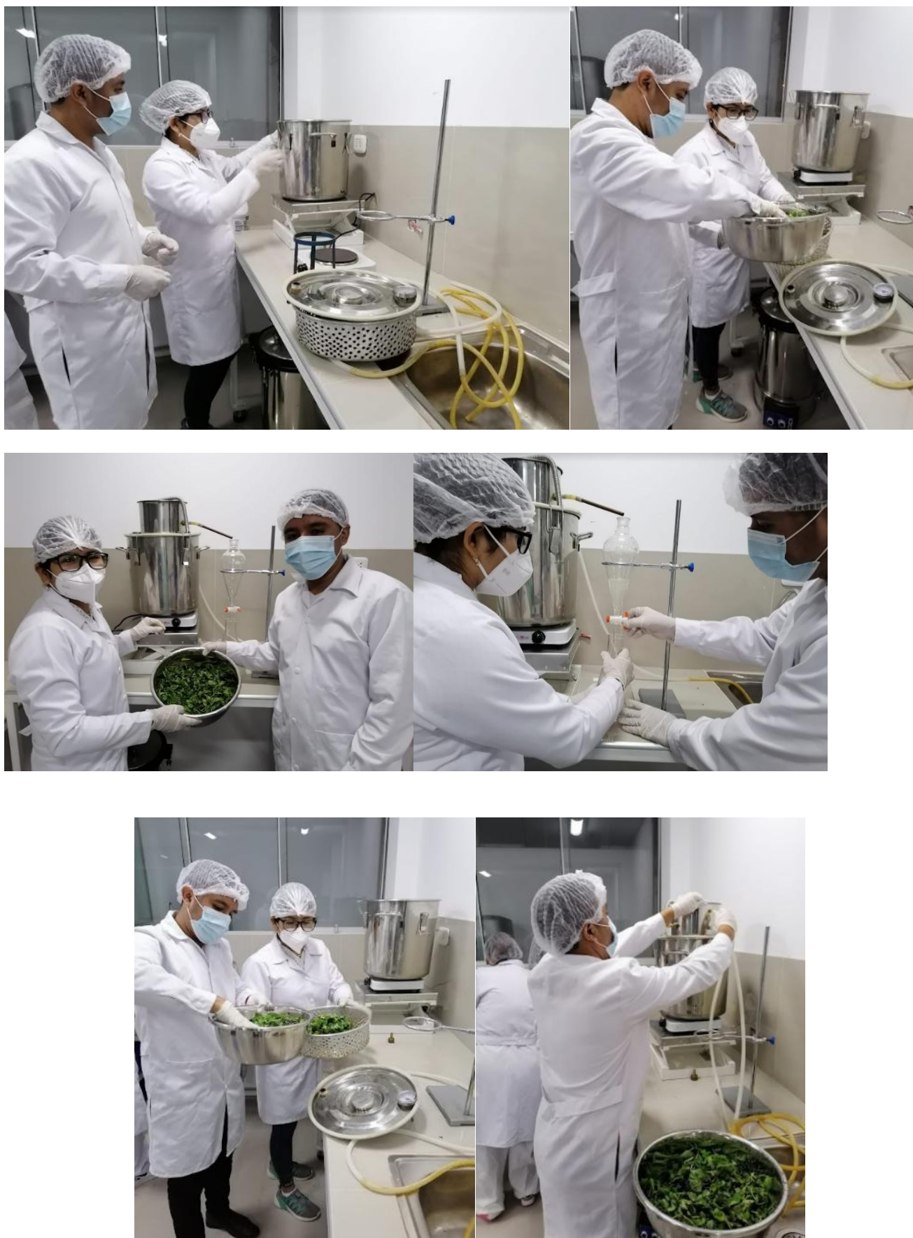
Figura 3. Instalación del equipo de destilación por arrastre con vapor y obtención del aceite
