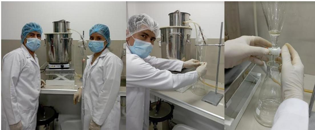
Figura 4. Obtención del aceite esencial por destilación con arrastre de vapor
