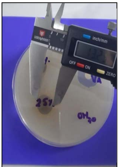
Medida de halos de inhibición de sustancias experimentales enfrentadas con S. aureus
